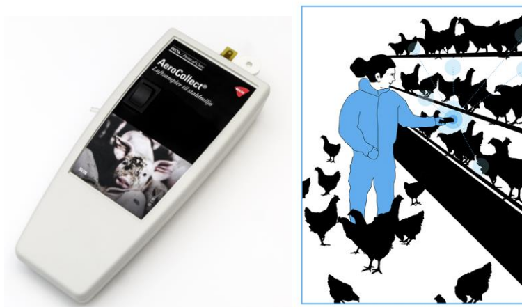
Figur 5 AeroCollect® systemet til indfangning af mulige patogener fra luften i veterinære miljøer. Til venstre ses selve systemet, som er et håndholdt udstyr, som ved hjælp af elektrostatiske kræfter fanger luftbårne/støvbårne patogener i chippen, som ses i toppen af udstyret. Til højre ses en illustration af brugen af AeroCollect® i brug i en hønsefarm.
